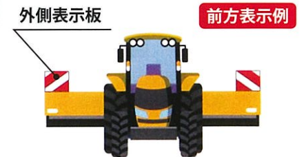
制限標識ステッカー取付見本
